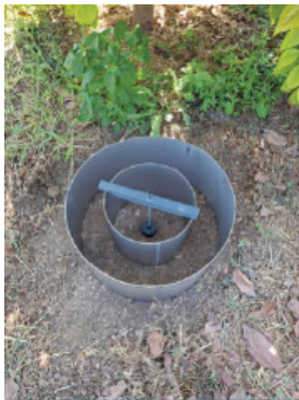
Μέτρηση της διήθησης στο χωράφι.
